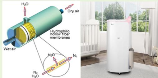
그림 2 분리막 제습 시스템 및 가정용 제습기
