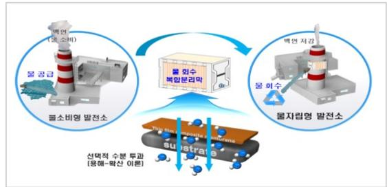
그림 1 제습/재생 모듈 기술의 냉각탑 내 적용 예 그림 2 선택적 수분 투과 원리를 이용한 물회수 복합분리막
